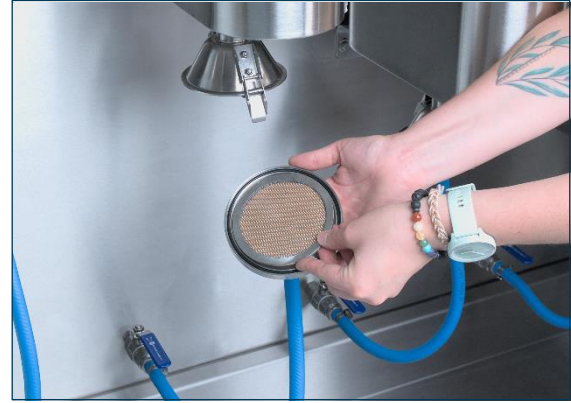
Umieszczanie ekranu w uchwycie
