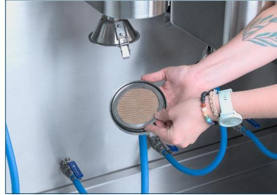
einfaches Einsetzen des Filtersiebes
