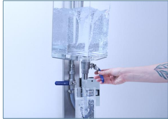
Pobieranie próbki za pomocą zaworu kulowego
